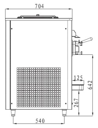
Requerimentos: É necessário um circuito elétrico dedicado, para manutenção da estabilidade da tensão quando o equipamento está ligado;
